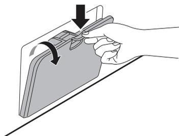
**3** Comece por remover o tampão de drenagem do tubo de drenagem, e de seguida deixe a água escorrer.
