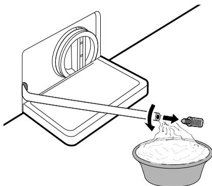
**4** Desaperte lentamente o filtro da bomba de drenagem para deixar escorrer o resto da água, e de seguida remova do filtro quaisquer resíduos ou objetos.
