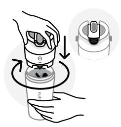
3 Enrosque o conjunto de base do motor, lâmina e tampa no copo triturador. Certifique-se de que a tampa rebatível (fliptop) está fechada e vedada.
