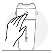
4 Com o liquidificador virado para cima (conjunto de base do motor, lâmina e tampa em cima), prima uma vez o botão de ligar para ativar o liquidificador. Aguarde cerca de 1 segundo até que o anel luminoso de LEDs se acenda completamente.
